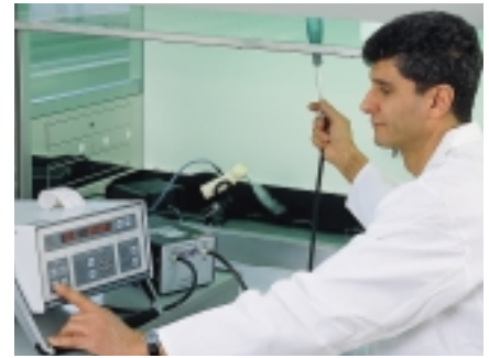
Einzelüberprüfung der Filterdichtigkeit in unserem Qualitätslabor ▲
