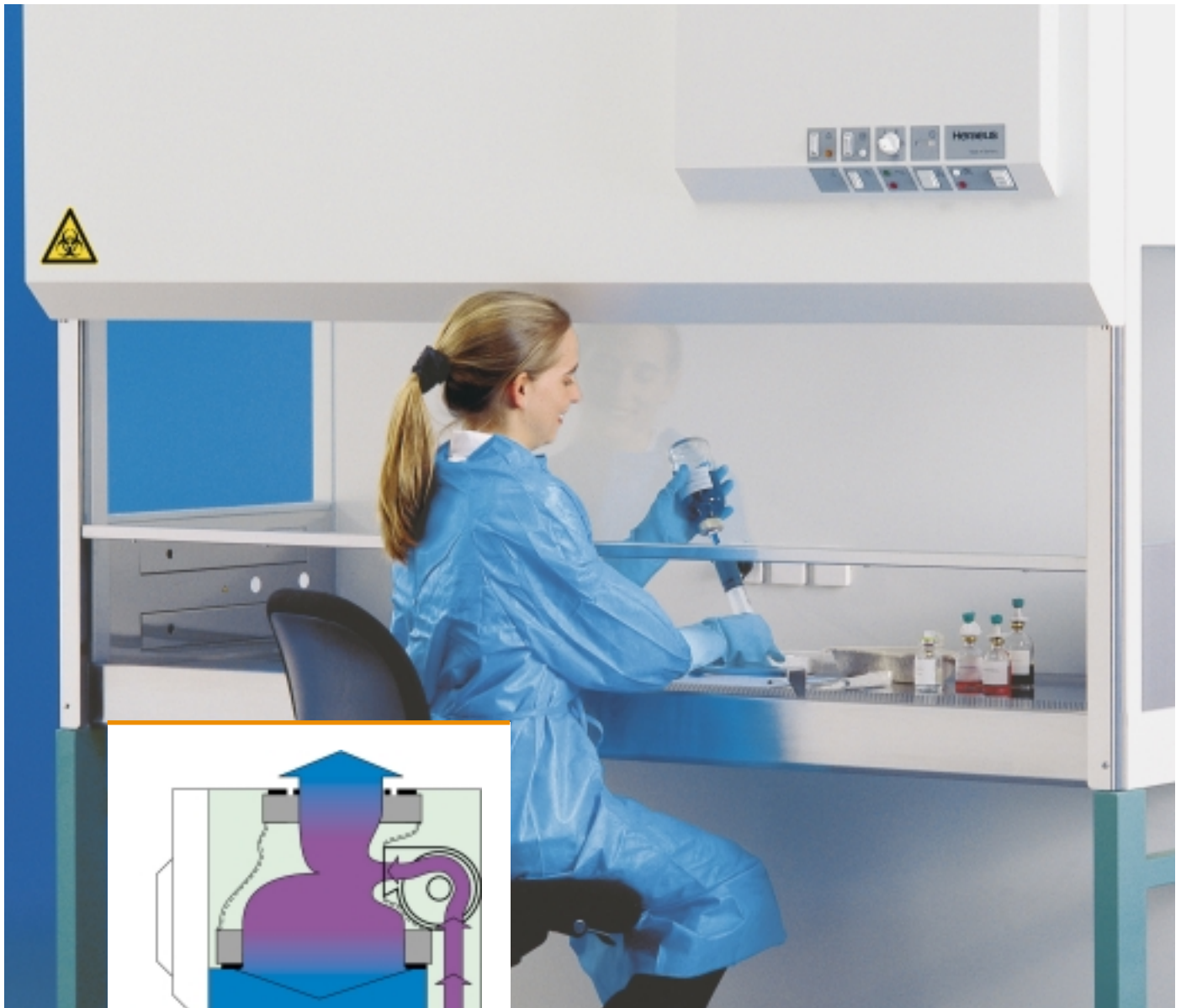
Luftführungsschemata HERAsafe HSP/HSPC (Vorfilter als Kohlefilter)
